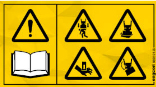
Afbeelding40. Waarschuingssticker op de kantelcilinder (EC206-EC233).
