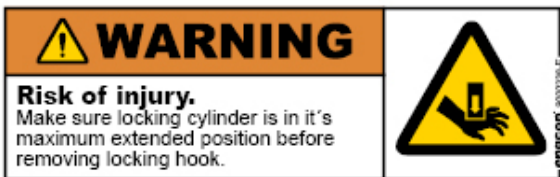
Afbeelding42. Waarschuingssticker op vergrendelcilinder.
