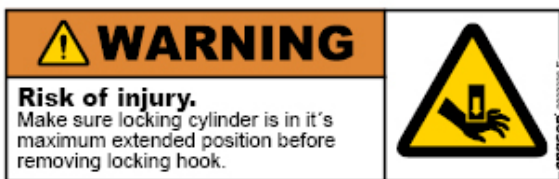
Afbeelding42. Waarschuingssticker op vergrendelcilinder.
