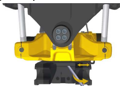
Afbeelding37. Draai de snelwissel naar rechts.
