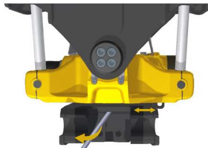
Afbeelding35. Draai de snelwissel naar links.
