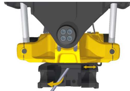
Afbeelding36. Draai de snelwissel naar links.
