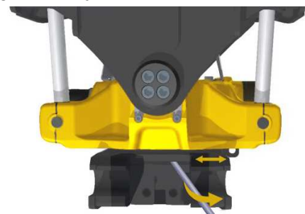
Afbeelding38. Draai de snelwissel naar rechts.
