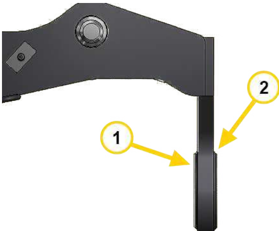
Afbeelding26. Vervanging van de kantelasbus.
