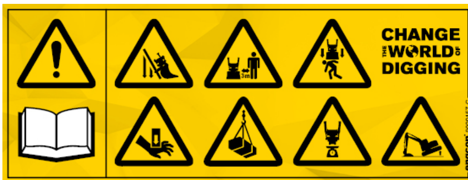
Afbeelding1. Waarschuwingsticker aan rechterzijde van de machinist.
